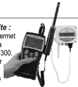
L'ajustage des capteurs en plusieurs points reste possible. L'ajustage de la pression atmosphérique sur site est réalisable par correction avec un offset après comparaison des valeurs obtenues à la pression ambiante.
