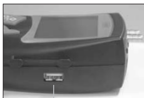
Port USB pour branchement de l'imprimante et raccordement à un PC
