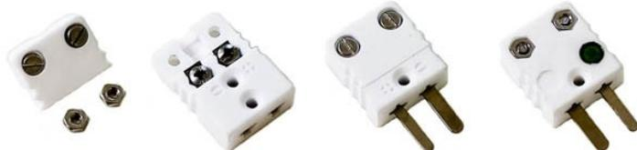
Connecteur **deux broches plates** pour la connexion des thermocouples et/ou avec des câbles de compensation ou d'extension. Un système de détrompeur empêche l'inversion de polarité.
