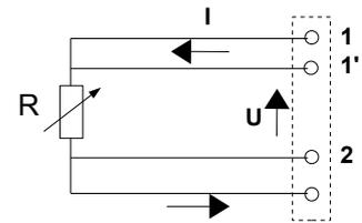
On fait passer un courant constant par les bornes 11' et 22' et l'on mesure directement la tension aux bornes de l'élément sensible, ce qui permet complètement de s'affranchir des résistances de lignes. C'est le montage le plus précis.
