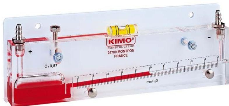
Les manomètres à colonne de liquide inclinée de la gamme TX, développés et fabriqués par KIMO, sont destinés aux mesures de faibles variations de pression, dépression, pression différentielle.
