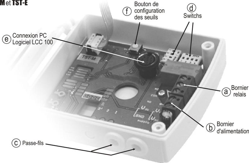
(c) Passe-fils : pour insérer un câble, il est nécessaire de faire une petite entaille avec un objet pointu dans la membrane de caoutchouc.
